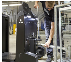
Manuell betätigte Anhängerkupplung.
