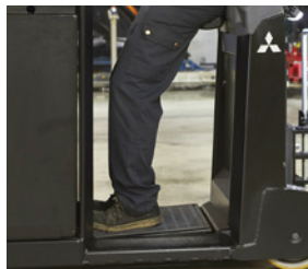
Schwebend aufgehängter Fahrerstand.
